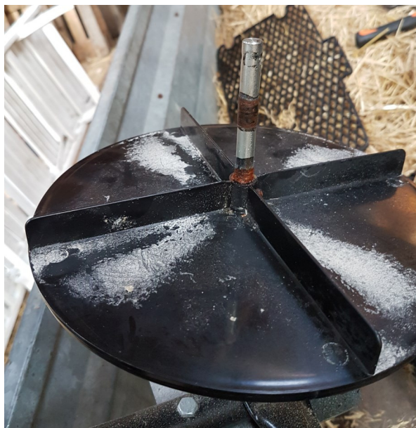
Rusten aksel på centrifugalspreder
